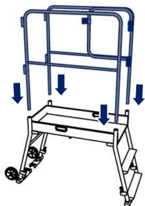
**4** Insérer les garde-corps dans les montants des piétements. Le garde-corps avec portillon se positionne à droite.
