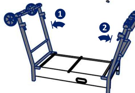
**2** Ouvrir les piétements de support 1 puis de montée 2, jusqu'en butée.
